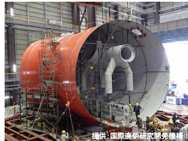
(2) ロボット試験用水槽
