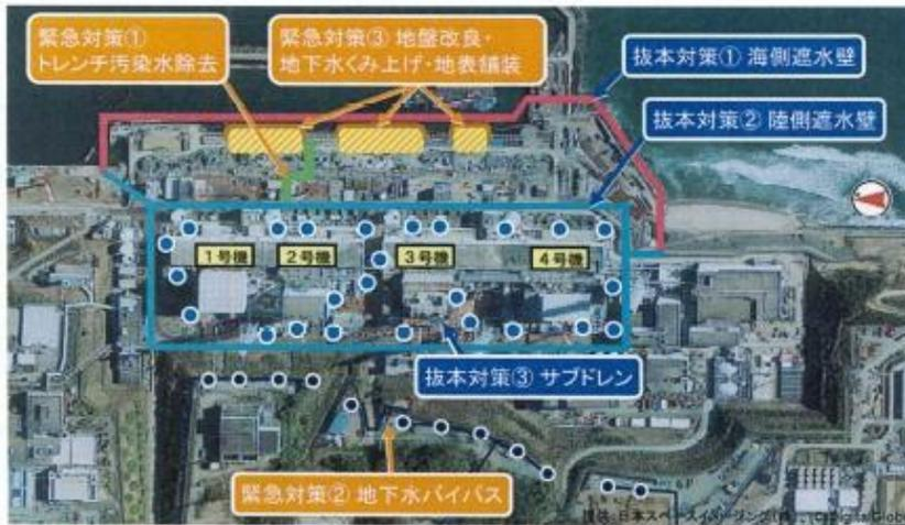
抜本対策② 陸側遮水壁(凍土方式)の設置 汚染水増加抑制・港湾流出の防止
