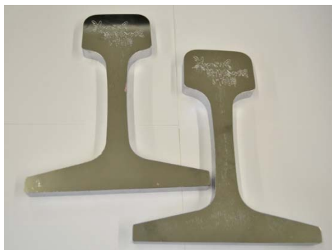
4 新幹線レールと同素材、同形状のプレート
