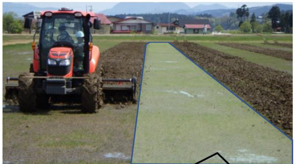
画像2 自動操舵（直線キープ）の稼働状況
