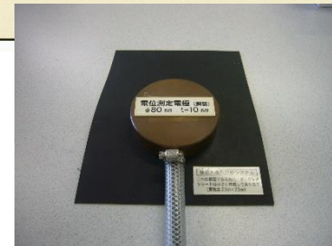
漏水検知システムの電極
