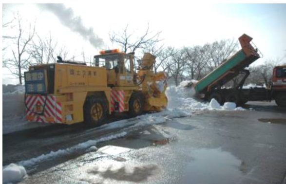
【高田城址公園南堀への投入】 （国土交通省 高出力ロータリー除雪車）
