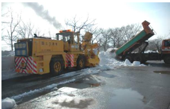
【高田城址公園南堀への投入】 （国土交通省 高出力ロータリー除雪車）
