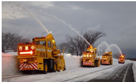
【北陸自動車道 (大湊 PA 付近)】 (ロータリー除雪車による梯団除雪の状況) 1 月 13 日撮影
