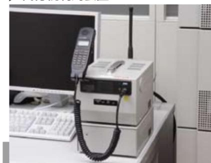
統制局設備に障害が発生した場合に統制局の代行通信を行います。
