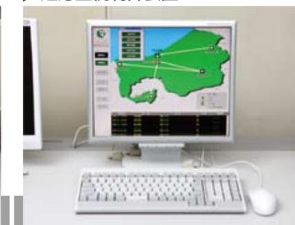
多重無線設備の回線状況および中継局設備の状態監視・制御を行います。
