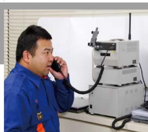
全ての区総合事務所に設置しています。送信出力が5Wで移動局間での直接通信時に、広範囲なエリアでの通信が可能です。また、非常用の蓄電池を装備しており、災害時には持ち出して使用することもできます。
