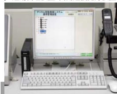
デジタル移動無線網の回線状況の監視・制御および通信の記録・集計を行います。
