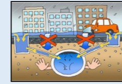
下水道の排水能力超え
