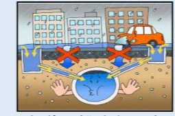
下水道の排水能力超え
