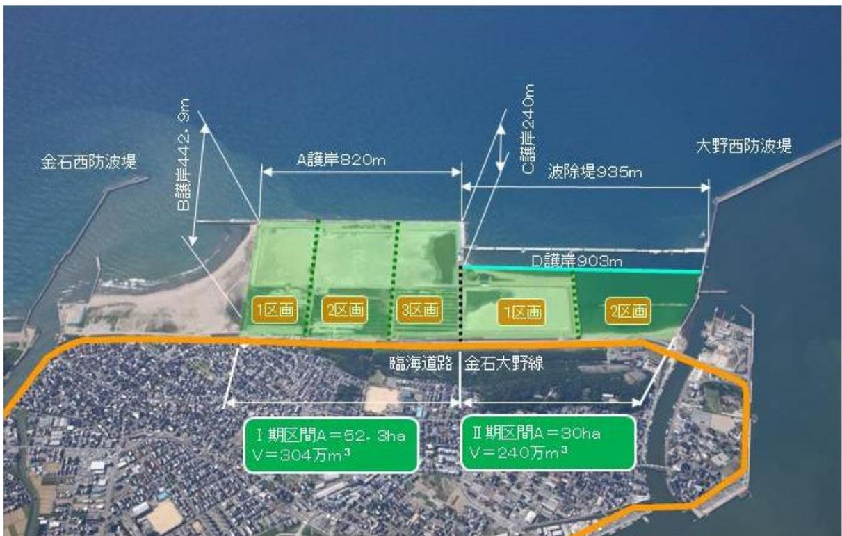
図 3-5 金沢港浚渫土砂埋立護岸整備事業
