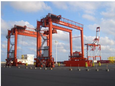
写真 2-2 北ふ頭（ガントリークレーンとトランスファークレーン）
