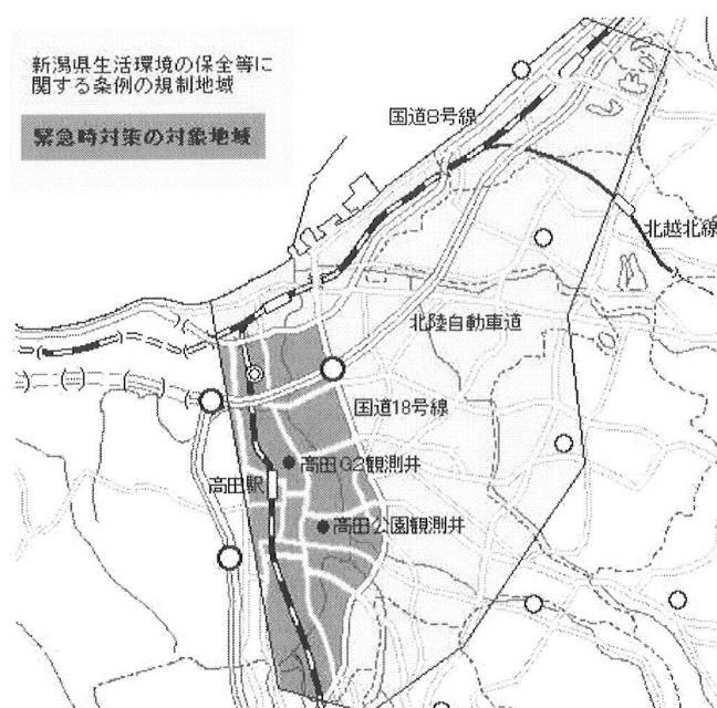
図 3-3 揚水規制区域
