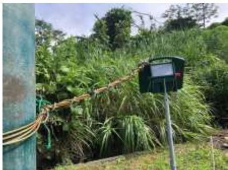
【対策案②】電気柵本体機を近くに打った杭などに、金属製ワイヤーで結着する。
