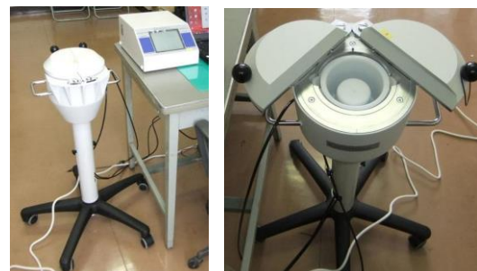
ベルトールド社(独)製 「ガンマ線スペクトロメータ Lb2045」
