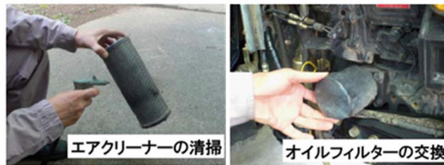
エンジンの保守点検の例 (トラクター、コンバイン等)
