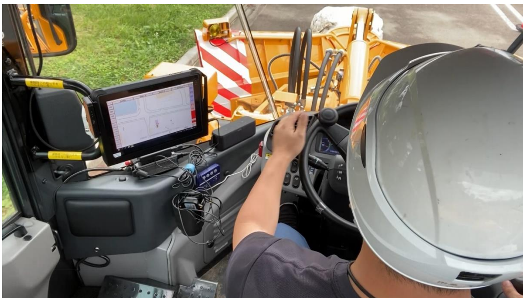
写真1 「スマート除雪ナビ」を取り付けた除雪ドーザ
