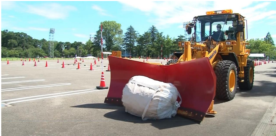
写真4 雪に見立てた1tパックを押す除雪ドーザ
