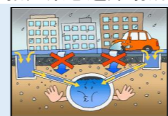
下水道の排水能力超え
