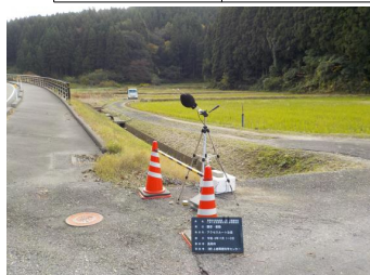
騒音計、振動計設置状況
