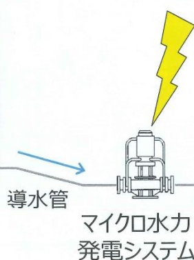
マイクロ水力発電システム 22kWクラス2台並列設置
