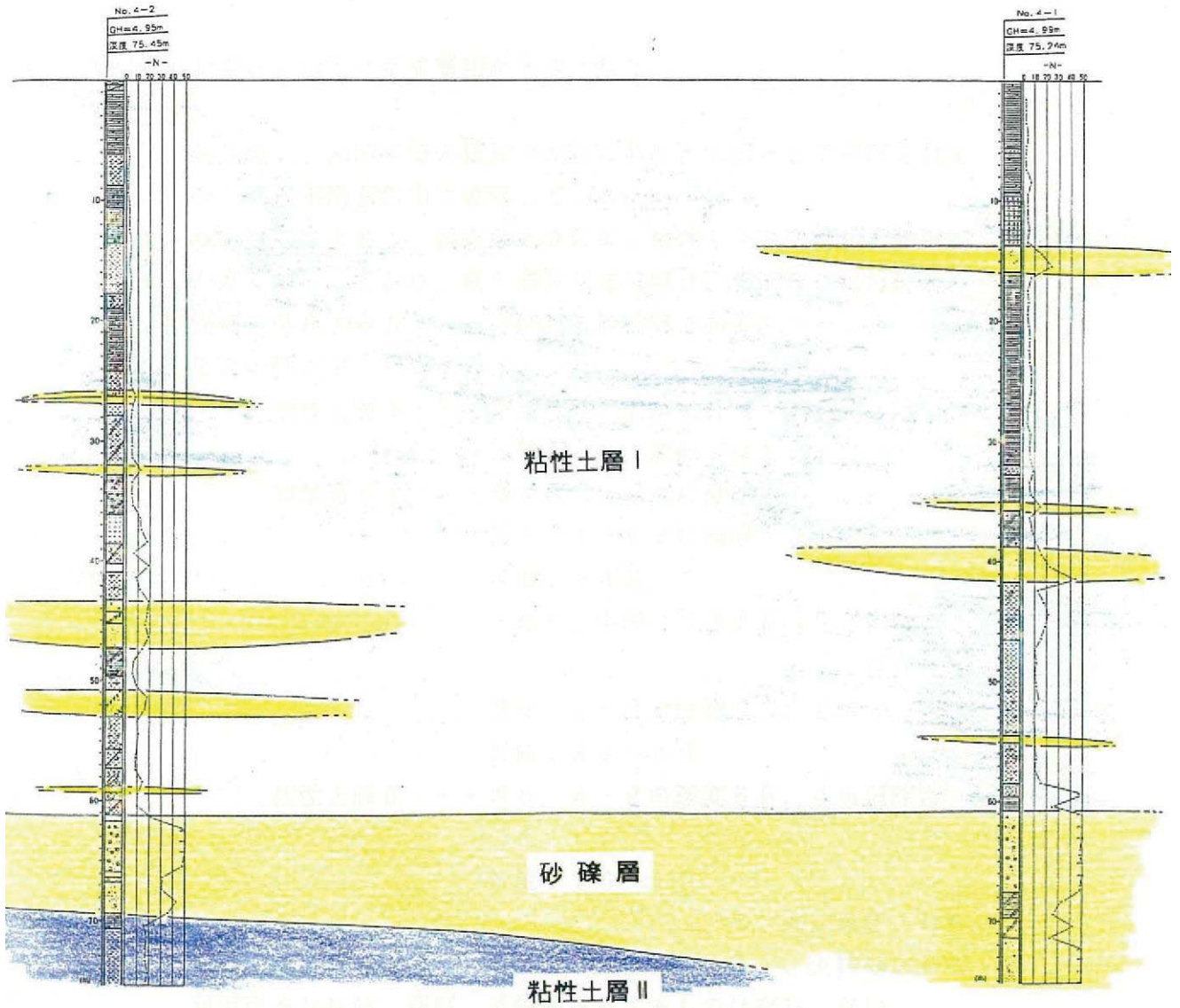
図-3.1.2. 平成4年度調査時推定地質断面図 Not scale
